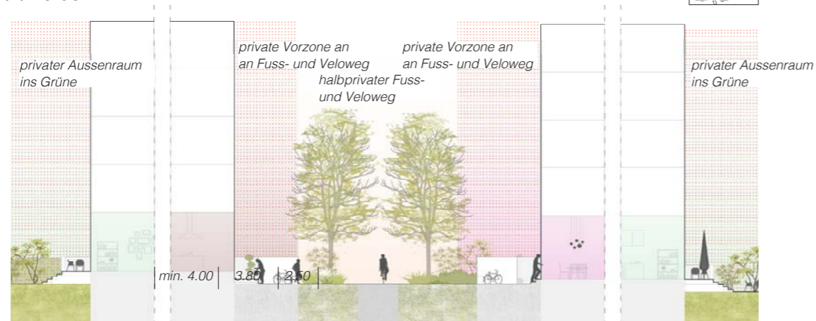
Abb. 52 Schemaschnitt Nebenerschliessung in den Südfeldern
